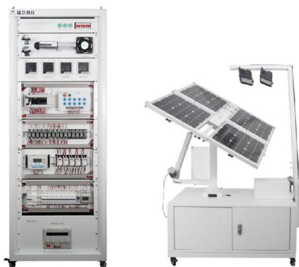
图 2.2.1 分布式光伏工程实训系统硬件外观图
